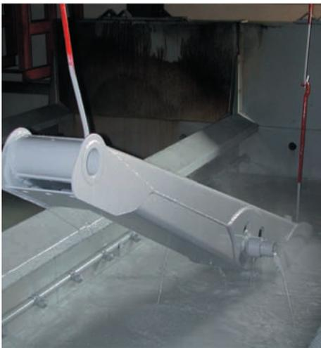
**KTL-Grundierung** mit anschließendem Einbrennvorgang bei 160°C
