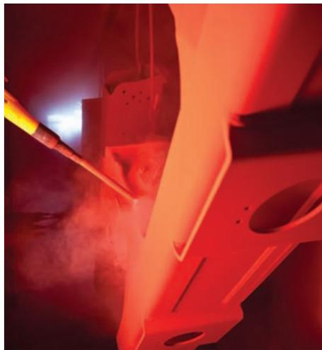
**Pulverbeschichtung** mit anschließendem Einbrennvorgang bei 200°C
