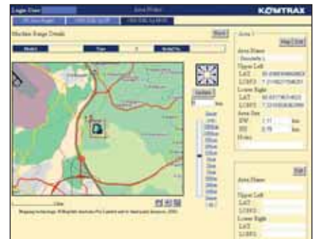
Nagyobb biztonság – A “motor letiltás” funkció segítségével meghatározható, hogy a gép mikor indítható be. Továbbá a “körülhatárolt működési terület” (geo-fence) beállításával a Komtrax értesítést küld, hogy a gép a meghatározott munkaterületen belül vagy kívül tartózkodik-e.
