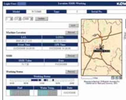
Gép munkaideje – A “napi munkanapló” pontos adatot szolgáltat a motor működési idejéről: mikor indították be a gépet és mikor állították le, valamint tájékoztat a motor teljes üzemidejéről.
